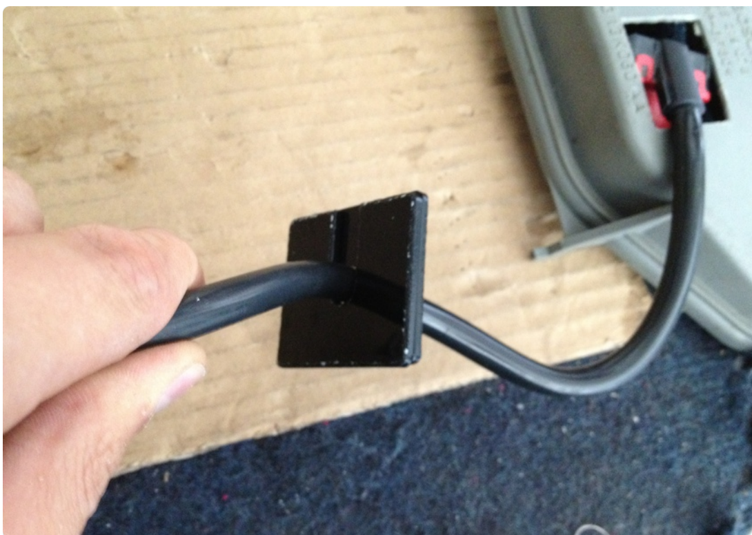
OBRAZEK 1.10 Przewód w skleionej przelotce powinien być umocowany ciasno i praktycznie się w niej nie ruszać.
