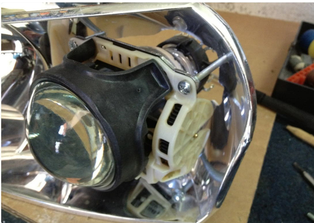
OBRAZEK 1.4 Mocowanie na śrubach pozwala na regulację soczewki oraz łatwą wymianę w razie uszkodzenia.
