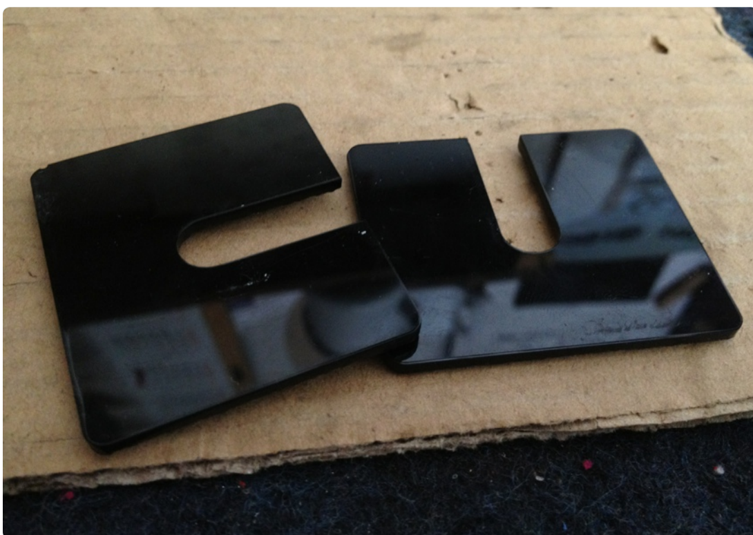
OBRAZEK 1.9 Części przelotki najlepiej wykonać z czarnego materiału, aby nie wyróżniały się od przewodu.
